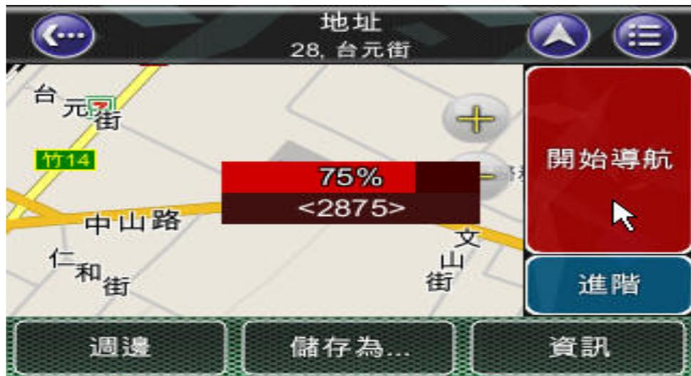
在 GPS 衛星訊號未定位的情況下，導航軟體將以 GPS 上次定位到的位置做為起點來規劃您的行程。(簡單得知您的衛星訊號是否定位，請看代表車輛位置的三角型標誌，若為綠色代表定位，若為紅色代表未定位。詳見 4.2.2 節 地圖顯示 P.27 說明)
