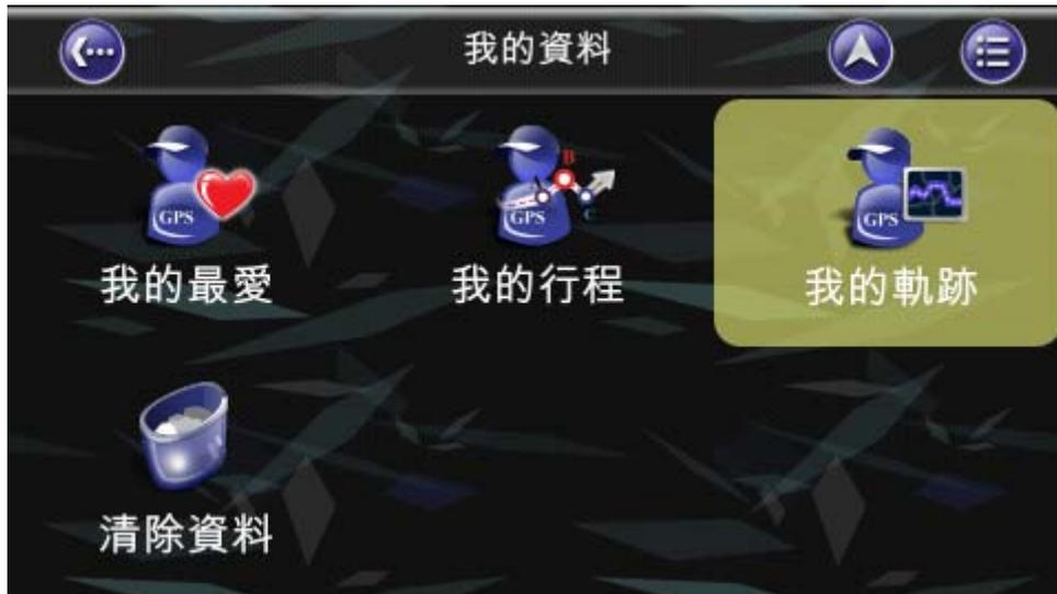
軌跡的設定讓您可以記錄和命名您的旅行軌道/路徑。此時，您必須在 GPS 衛星定位的情況。記錄下來的軌可做為您將來到目的地的一個參考。您可以儲存和載入（顯示）這些軌跡資訊在日後使用。特別是在某些地圖未顯示的地區情況，因為無法計算到目的地的路徑。在同一時間只可以顯示一個軌跡。
