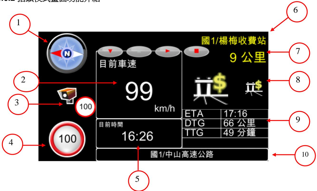
1. 指北針：顯示目前的 導航方向。點選指北針可以切換 2D 正北朝上、2D 車頭朝上、3D 車頭朝上及抬頭模式等。
