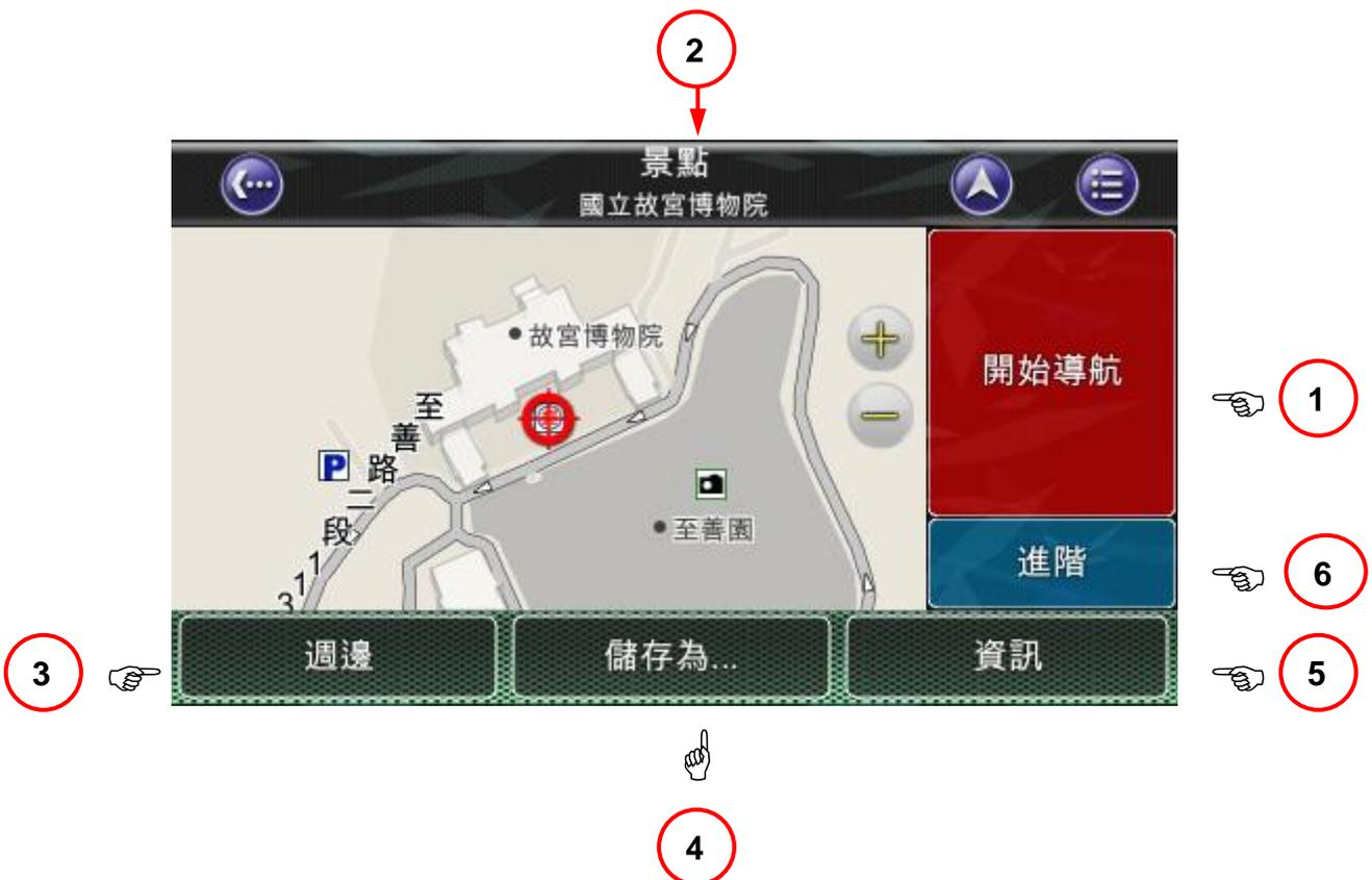
**1. 開始導航：** 將選擇的地點設為路徑規劃/行程模擬的起點。點選地圖畫面上的位置時，畫面的下方會出現該位置的訊息列。點選訊息列，可以來到位置選單，接下來點選開始導航，軟體會開始計算最佳路徑。
